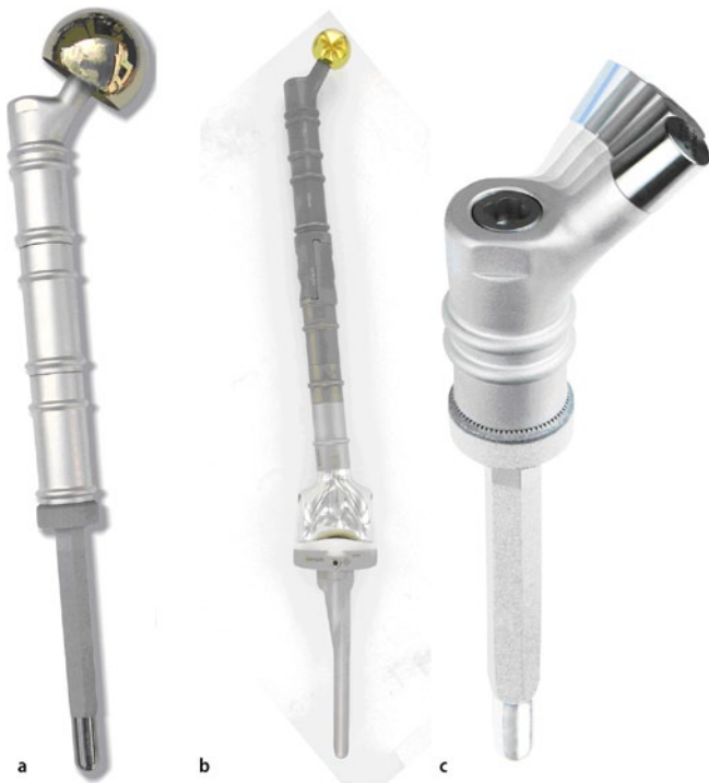
Abb. 1 ◀ Das proximale MUTARS®-Femur (a) und das totale MUTARS®-Femur (b) mit silberbeschichteter Oberfläche. Einstellung der Ante-/Retroversion des Prothesenhalses über die Stirnverzahnung in 5°-Schritten (c). (Mit freundlicher Genehmigung der Firma implantcast.)
